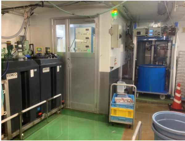
図2 アニサキス殺虫プロトタイプ機及び処理槽に魚身を入れた状態 工場に設置したアニサキス殺虫装置プロトタイプ機は、冷塩水生成装置、パルス電源、処理槽からなります。処理槽に魚身を入れて処理を行います。
