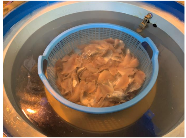
図2 アニサキス殺虫プロトタイプ機及び処理槽に魚身を入れた状態 工場に設置したアニサキス殺虫装置プロトタイプ機は、冷塩水生成装置、パルス電源、処理槽からなります。処理槽に魚身を入れて処理を行います。
